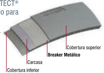
**ARAMIDA MAX PROTECT®** – El diferencial de este producto reside en su eficacia al combinar la resistencia a la perforación y cortes de la Cobertura ARAMIDA MAX PROTECT® con su capacidad de operar en medio a los equipamientos con detectores de metales, sin generar interferencias.
